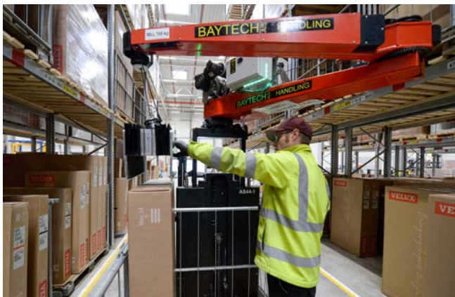
Kommissionierung der Fenster mit speziellem Kranaufbau für den Toyota BT Optio Niederhubkommissionierer
