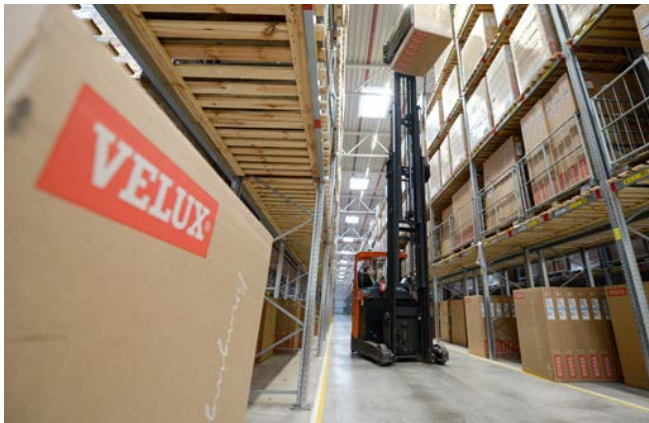
Handling der Fenster-Cubes mit Klammer am Toyota BT Reflex Schubmaststapler
